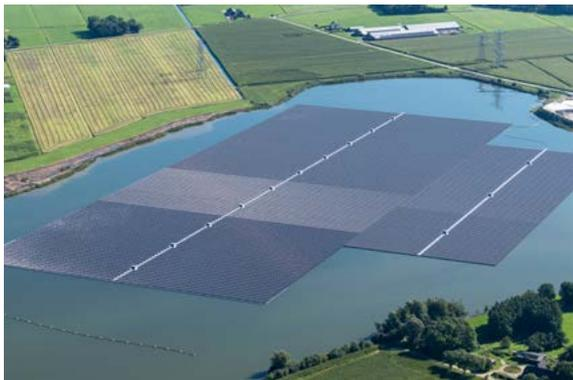
**Schwimmender Solarpark:** Eine solche Anlage wurde 2021 zum ersten Mal in Differdingen installiert. Bestehend aus 25.000 m<sup>2</sup> Solarzellen, beträgt die Stromproduktion 3 GWh/Jahr, was dem Bedarf von fast 800 Wohnungen pro Jahr (3.200 Personen) entspricht.
